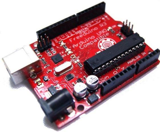
Además de las entradas digitales un Arduino tiene entradas analógicas que nos permiten medir las señales de sensores análogos. Para poder visualizar la información, se cuenta con un puerto de comunicación Serial-USB que mediante un puerto USB, de una computadora, nos permite enviar y recibir mensajes digitales mediante una USART o también llamada UART.
